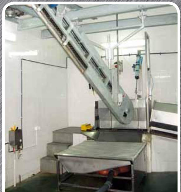
Podajnik różnicowy na tor do wykrawiania Differential conveyor towards bleeding section
