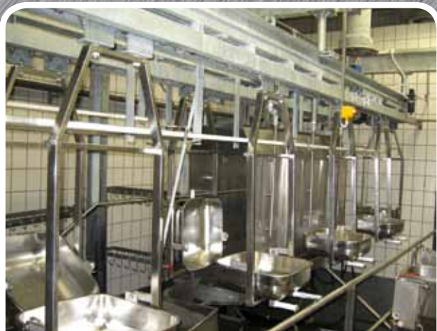
Przenośnik do transportu jelit i ośrodków Conveyor for intestinal and bowel transportation
