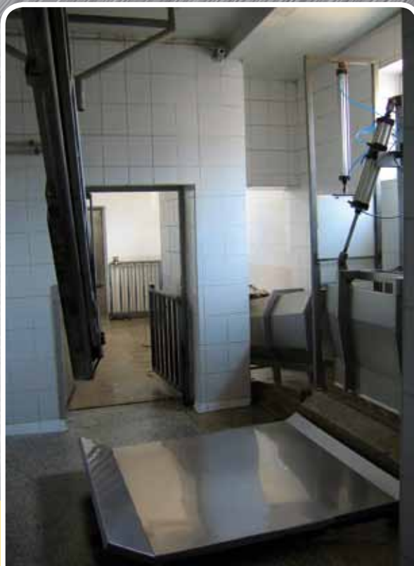
Kojec ubojowy z tapczanem wyrzutowym Killing box with an ejection couch
