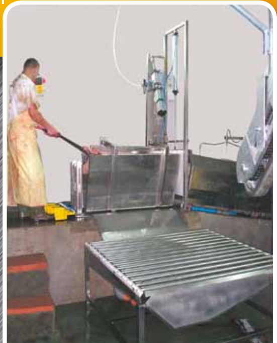
Kojac ubojowy trzody ze stołem rolkowym do wykrawiania Pneumatic stunning box for pigs
